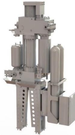
Die vertikale Anordnung des Gießaggregats sorgt für einen 100 prozentigen Füllgrad der Gießkammer und eliminiert die bekannte Problematik von Lufteinschlüssen während der 1. Phase des Formfüllprozesses (Abbildung). Durch den Einsatz einer vertikalen Gießkammer ist der Füllkammerverschleiß beim Dosieren der Legierung deutlich geringer im Gegensatz zu einer horizontal verbauten Füllkammer. Der verbesserte Wärmehaushalt verhindert zudem die Entstehung des "Bananeneffektes".
