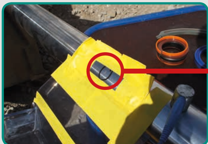
Reparatur einer Kolbenstange mit Dichtungstausch
